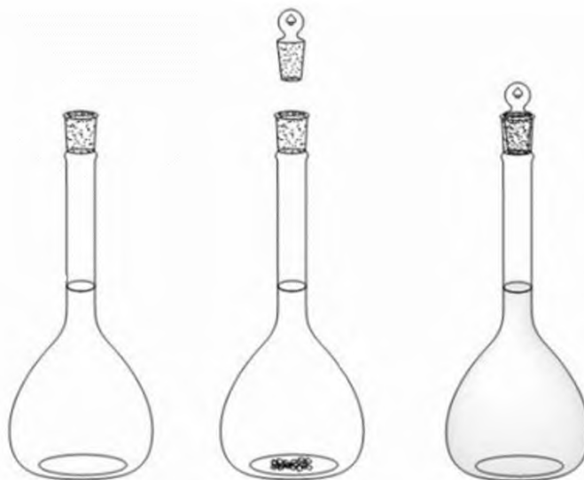
Приготовление первичного стандартного раствора из кристаллического стандартного вещества
