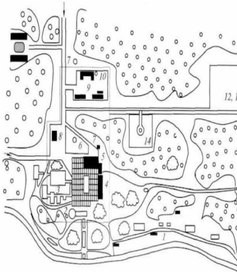
Рисунок 3 - Генеральный план курортной гостиницы: 1 — пляж; 2 — танцевальная площадка на 100 человек; 3 — спортивные площадки; 4 — спальный корпус на 300 мест; 5 — клуб-столовая; 6 — пожарный резервуар; 7 — трансформаторная подстанция; 8 — административно-приемный корпус; 9 — овощехранилище; 10 — хозяйственный корпус; 11 — жилые дома персонала; 12 — канализационная насосная станция; 13 — очистные сооружения; 14 — насосная станция с артезианской скважиной; -\*. — подъезд с трассы.
