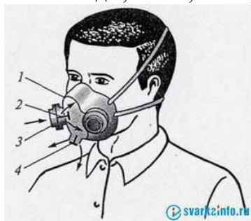
Рис. Патронный респиратор: 1 — полумаска; 2 — клапан вдоха; 3 — фильтрующий патрон; 4 — клапан выдоха
