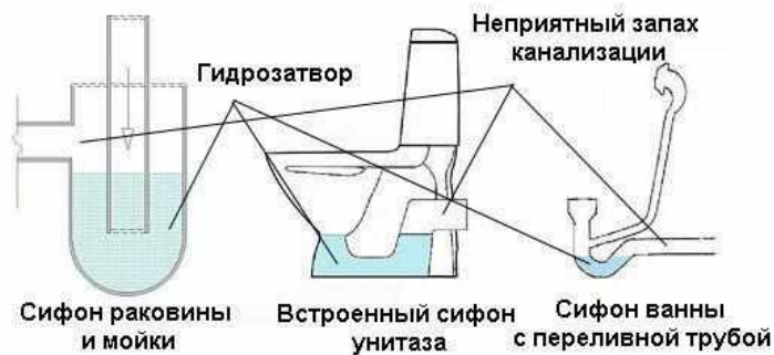
Принцип работы сифона (гидрозатвор)
